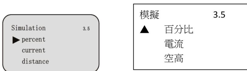
用 [↻] 鍵選擇電流輸出映射方式，按 **OK** 鍵確認，進入相關的設置選單，完成數值設置後，按 **OK** 鍵確認，此時，相關的電流輸出設置值所對應的電流值。
