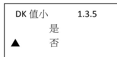
按 [↺] 鍵選擇“是”，用於 DK 值小時的測量設定，液晶顯示如下，這時需要人工輸入一個準確的空桶空高值，該值用於判斷桶底的位置，以減少桶底的反射。
