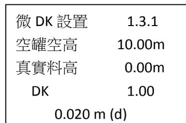
選擇物料性質為微 DK 時，一般用於介電常數小於 1.4，這時介質表面的直接回波很弱，或不能測量，而通過桶底反射的方法可以測得料位高度，這時需要輸入以下參數中的兩個：1.空桶空高，空桶或空容器的空高值。2.真實料高或待測物質的介電常數，這兩個參數關聯，輸入其中之一即可。以上參數的精度直接影響測量結果精度值。
