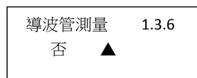
按 OK 鍵進入導波管測量選擇選單，液晶顯示
