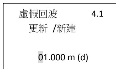
提示輸入真實回波距離值，輸入距離值後，按 OK 鍵確認，液晶顯示請等待，儀表進行虛假回波的學習，完成後退到虛假回波學習選單。
