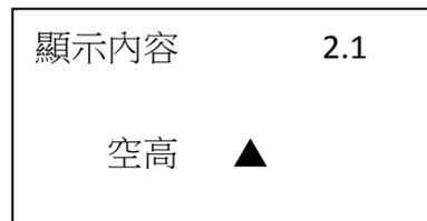
表示當前顯示內容的參數是空高，即儀表顯示測量的空高值。按 OK 鍵，進入編輯狀態，液晶顯示
