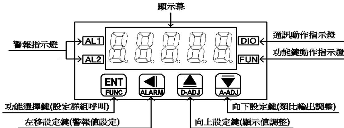
註:在正常顯示值時,同時按▲&▼鍵超過 5 秒以上,則清除目前最大/最小值保持值,重新新的最大/最小保持值
